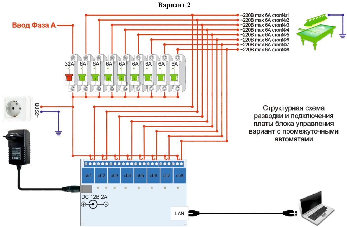
**Схема подключения 16-ти канального блока**
