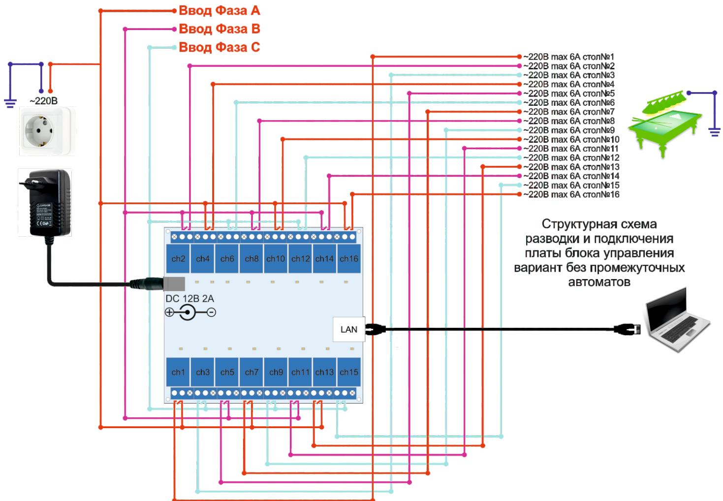
**Схема подключения 16-ти канального блока**
