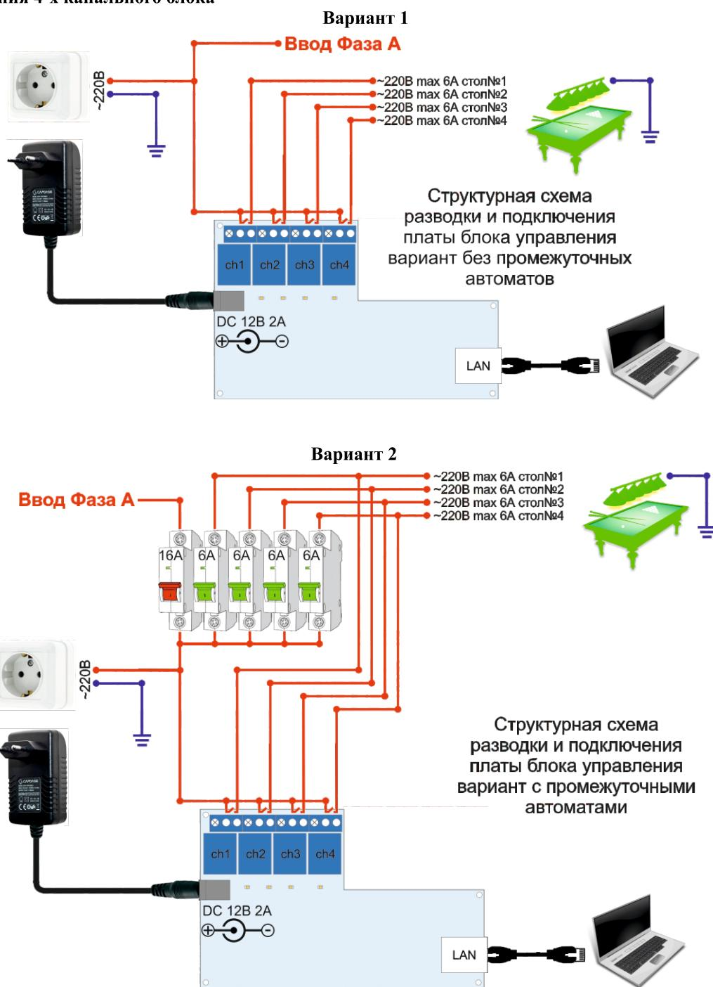
Схема подключения 8-ми канального блока
